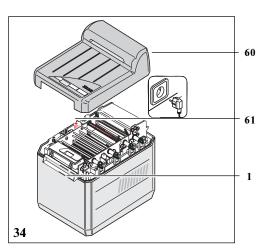
Роликовую группу положить в емкость для, промывки, смочить средством "Sprühreiniger WR 2000" и дать подействовать в течение 10 мин.
