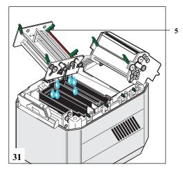
Поднять роликовую группу проявителя и фиксажа (5), опрокинуть на бок для стекания химикатов.
