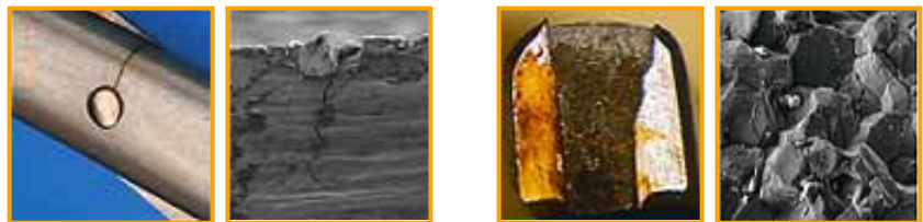
Detalle: articulación final de tijeras con hendidura intercristalina típica.
