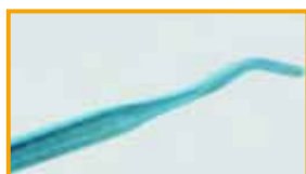
Espátula de empaste corroída. Causa: adherencia de material debido a eliminadores de cemento ácido
