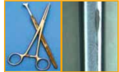
Corrosión de contacto: Acero inoxidable/latón
