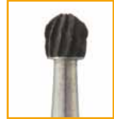
Broca de metal duro de WC/CO, corroída y gastada. Causa: utilización de un limpiador ácido.
