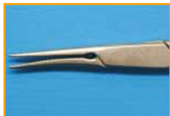
Deformación debida a manejo inadecuado
