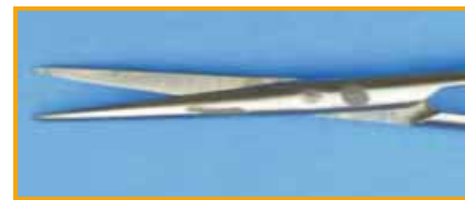
Izquierda: ataque parcial al material debido al uso de eliminador de cemento ácido, y en la derecha debido a tintura para el restañeo de la sangre. Causa: tiempo de contacto demasiado elevado o limpieza insuficiente tras la utilización.
