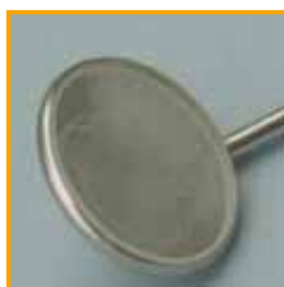
Manchas sobre instrumentos. Causa: secado de agua con elevado contenido de sal
