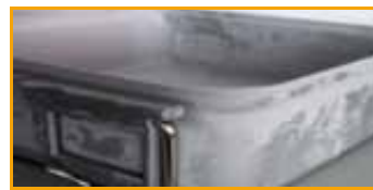
Fuerte ataque al material en superficies de aluminio natural o metalizado con un soporte de instrumentos o contenedor. Causa: sobredosificación de la solución de lavado normalmente compatible con el material.
