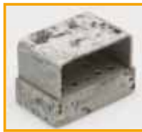
Fuerte ataque al material en superficies de aluminio natural o metalizado con un soporte de instrumentos o contenedor. Causa: sobredosificación de la solución de lavado normalmente compatible con el material.
