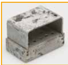
Soporte en aluminio anodizado fuertemente atacado
