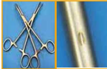
Corrosión de contacto: Acero inoxidable/ Acero inoxidable
