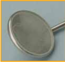
Manchas debidas a una cantidad elevada de sal en el aclarado final
