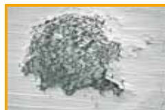
Korrosionsloch – betrachtet unter Rasterelektronenmikroskop – 200-fache Vergrößerung
