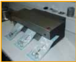
Versiegelung von Sterilverpackungen mittels eines Siegelgerätes.
