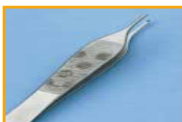
Flecken auf einer Pinzette: Ursache: Unzureichende Dampfqualität
