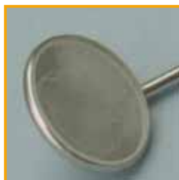
Flecken auf Instrumenten Ursache: Antrocknung von Wasser mit hohem Salzgehalt
