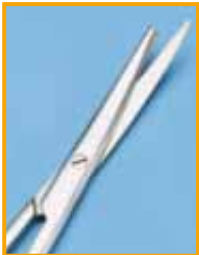
Schere mit abgebrochener Spitze. Ursache: unsachgemäßes Ablegen
