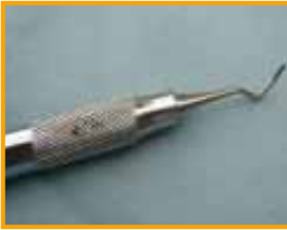
Blutrückstände an der Griffstruktur eines Instruments. Ursache: unzureichende Reinigung
