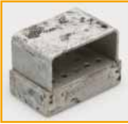
Stark angegriffener eloxierter Aluminiumständer
