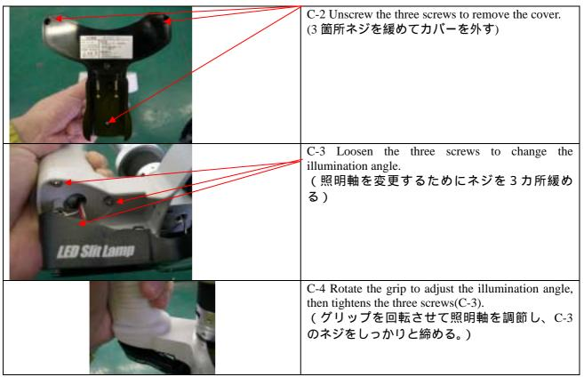
Slit light is shifting to upper side. (スリット光が上方向にズレている)
