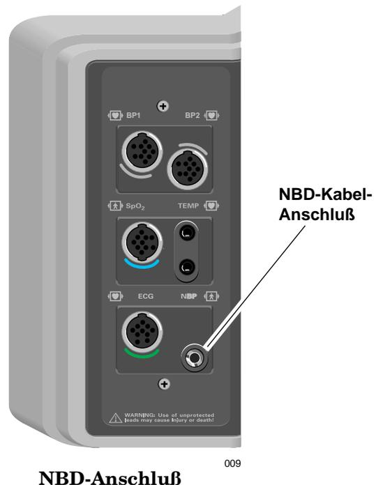
**HINWEIS:** Der Anschluß für den Manschettenschlauch ist isoliert und defibrillationsfest (☑️).
