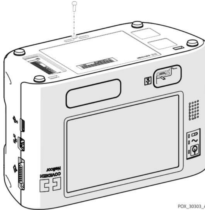
Figure 12-6. Parameter Module Screw Removal
